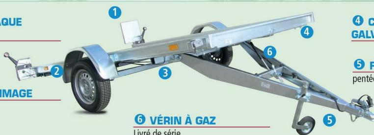
4 **CHÂSSIS SOUDÉ GALVANISÉ À CHAUD**
